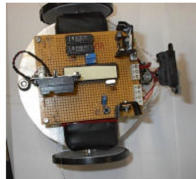
**Figura 5. Vista de la etapa de control y sensores.**
