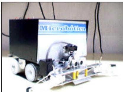
Para moverse utiliza unos motores Kelvin, con una caja reductora adecuada para una velocidad suficiente para afrontar su misión. Estos motores son alimentados con una tensión de hasta 12v.
