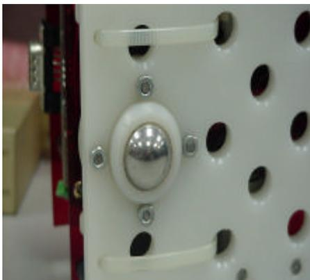
El radio de giro viene impuesto por la distancia entre el eje de las ruedas delanteras y el centro de la bola multidireccional siendo esta distancia de unos doce centímetros.
