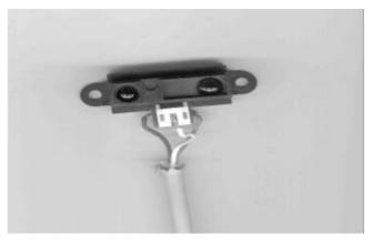
No es preciso añadir componentes externos a este dispositivo, basta con conectar la señal de salida del sensor directamente al microcontrolador.
