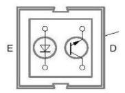
Los otros dos CNY70 forman parte del sistema de control del robot, dicho mecanismo será explicado con posterioridad, en lo que respecta a sus conexiones, deben estar polarizado con el ánodo a Vcc (al igual que el colector del transistor) mientras que los cátodos y emisores deber ser llevados a masa mediante resistencias que permitan el correcto funcionamiento de los diodos y transistor a la tensión de alimentación.
