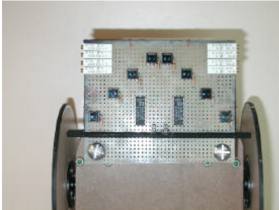
Fig.3. Disposición en V de los sensores.
