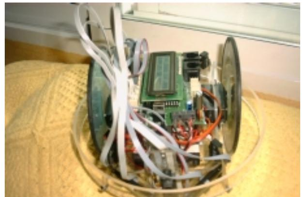
Para este diseño hemos utilizado la placa de control basada en el microcontrolador 16F877 de Microchip. Utilizamos un puente en H para el control de motores, un MAX-232 para comunicación con el PC, y los correspondientes puertos.
