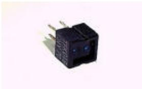
en la configuración que podemos ver en el esquema eléctrico. El emisor es abastecido constantemente, una resistencia de 100 ohmios permite una emisión potente. La salida del receptor se conecta al Vcc por medio de una resistencia Pull-Up. Según la luminosidad infrarroja recibida sobre la base
