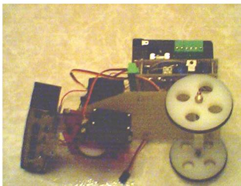
El radio de giro viene impuesto por la distancia entre el eje de las ruedas traseras y el de la rueda delantera, siendo esta distancia de unos doce centímetros. Para comprobar el correcto funcionamiento de los sensores se han dispuesto otros tantos led's en la tarjeta que serán operativos antes de activar el pulsador de marcha y en el inicio de la prueba los desactivaremos, para minimizar el consumo.
