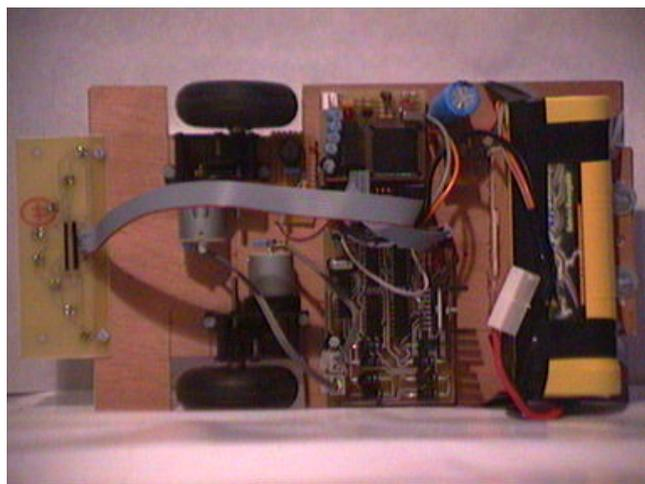
El microcontrolador recibe los datos de los sensores mediante un puerto de entrada paralelo. Estos sensores son 8 CNY70, que consisten en un fotodiodo como emisor y un fototransistor como receptor. Estos se han polarizado correctamente y se ha utilizado una resistencia de PULL-UP a la salida para conseguir niveles digitales.
