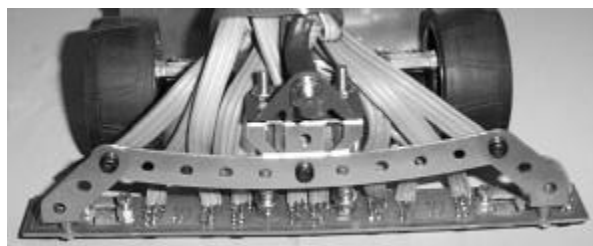
Fig. 3. Mecanismo de los sensores delanteros.
