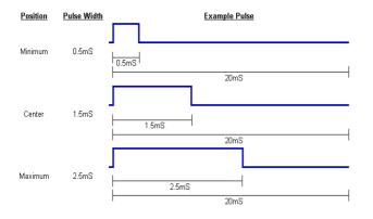
La PWM del motor será la encargada de regular la velocidad del robot mediante el control que hagamos de la potencia suministrada y de hacer que inicien su funcionamiento.
