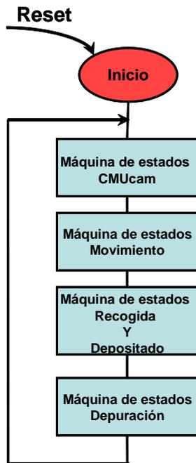
Figura 14. Esquema general de las máquinas de estado
