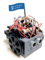
TuBot tiene la apariencia que muestra la fotografía, con un chasis de plástico impreso con impresora 3D en la propia Universidad y un cerebro basado en la arquitectura Arduino. Además incorpora un sensor de distancia, sensores capaces de seguir una línea en el suelo, LEDs, pulsador y dos LDR capaces de hacer que el robot detecte y siga a una luz.
